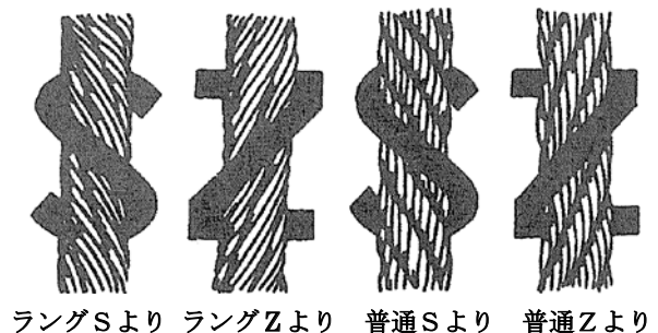
図3.63 ワイヤロープのより方
